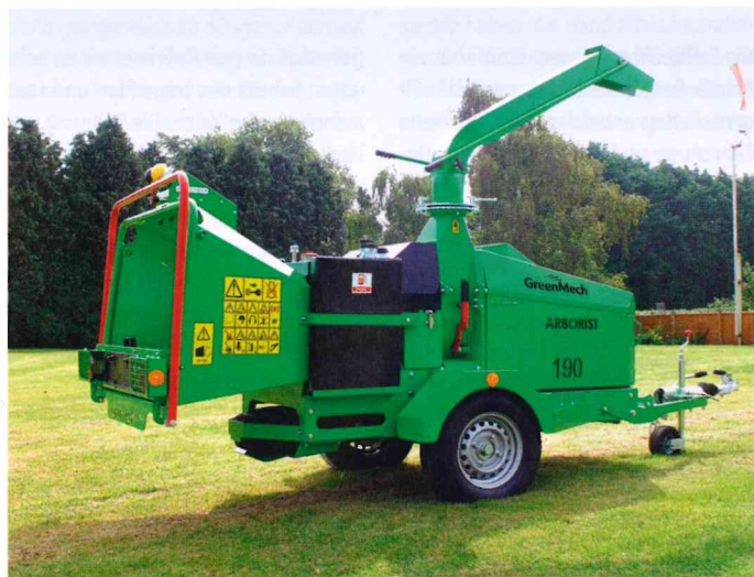
Der Anhänger-Häcksler Arborist 190 von Greenmech verfügt über eine vergrößerte Walzenöffnung und kann Stämme mit einem Durchmesser von 19 cm einziehen.
